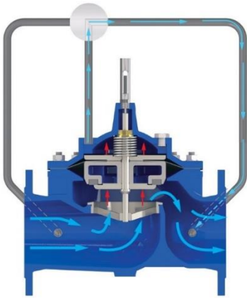
Ouverture de la vanne
