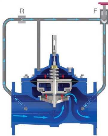
Vanne en régulation
