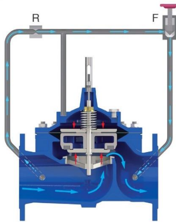
Vanne en régulation
