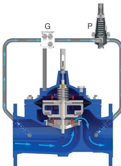
Vanne en régulation
